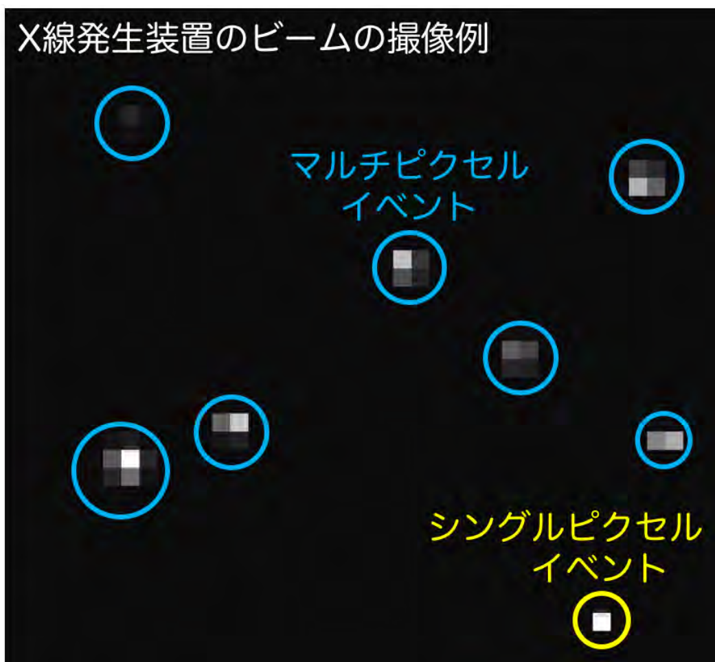
図 3.5: GSENSE2020BSI で撮像したフレームデータの拡大図。見やすさのため、イベントレートの高いフレームデータとして偏光 X 線ビームを測定したときのものを採用し（4.2 節参照）、ゲインを大きくして低エネルギーイベントでも判別しやすいようにしている。黄色の丸で囲まれているのがシングルピクセルイベント、水色がマルチピクセルイベントである（図 4.3 参照）。
