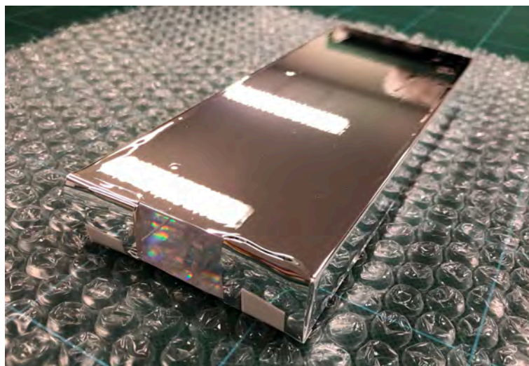
図 4.2: おもて粘着 ESR を貼った BGO の写真。ジーテック株式会社に外注して施行作業をしてもらったもの。
