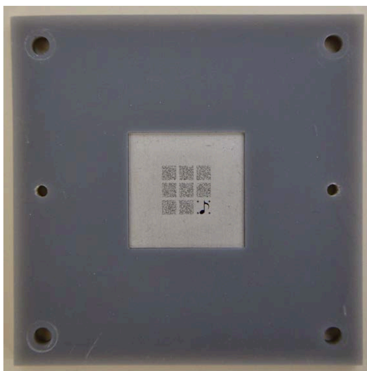
図 4.4: 実験で使った符号化開口マスクと、光学系取り付けのための治具。
