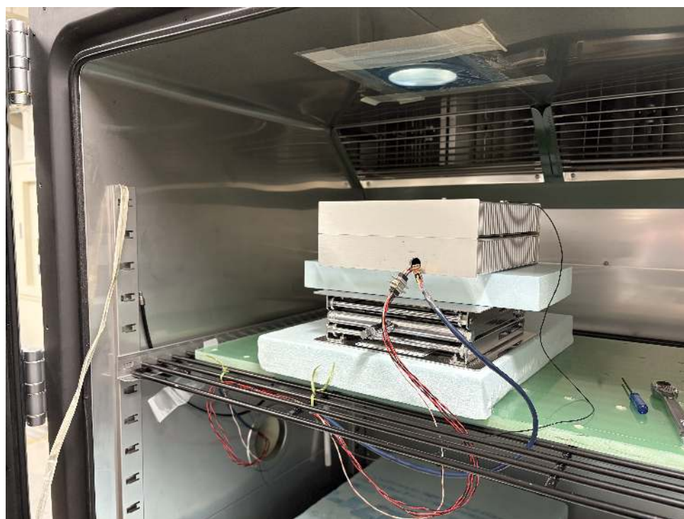
図 6.3: 恒温槽内部に配置された Si-DSD
